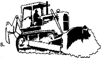
**Conclusión:** Por la increíble fuerza, dirección sensible, y por las rodadas abiertas lo cual comúnmente avientan lodo, pierdas, y escombros, *Bulldózer* no deben ser operado en proximidades cercas a personal no protegido. Si esto es inevitable, la maquina deber ser operada en las velocidades mas bajas posible para desempeñar la obra con el control del acelerador puesta en posición mas baja de lo normal mientras estas operaciones. Sigue estas pautas para operaciones seguros de *Bulldózer*.
