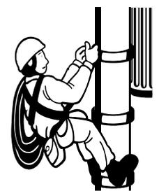
**El ancla** provee un punto seguro para enlaces de un lazo salvavidas, acollador, o dispositivo de deceleración. Deberá soportar una carga mínima de 5.000 lb. Nunca use alzamientos o barandales como anclajes; no son construidos a aguantar las fuerzas generado por una caída.
