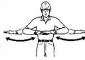
Alto de Emergencia
